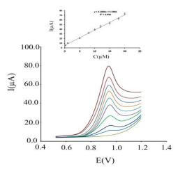
Fig. 4. DPVs of  $ZnFe_2O_4$  NPs/ reduced graphene oxide in 0.1 M PBS (pH 5.0) containing bentazon . Inset: DPVs of a) blank; b) 0.1; c) 1.0; d) 5.0; e) 8.0, f) 10.0; g) 12.0; h) 15.0; i) 18.0; j) 20 $\mu$ mol L<sup>-1</sup> of bentazon
